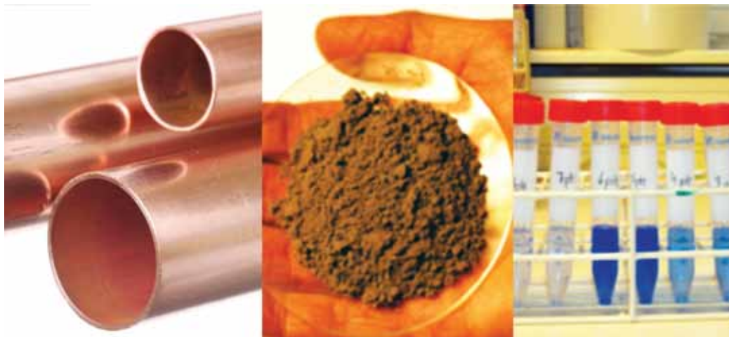
1. Kopparrör 2. Flygaska från avfallsförbränning 3. Lakvätska från aska lakad med ammoniumnitrat. Koppar-ammin-komplex ger den vackra blå färgen, ju blåare desto mer Cu i lösningen.
